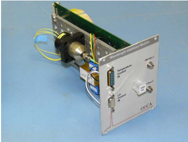
Laserdiodemodul mit Isolator und den beiden FC-APC-Ausgangsbuchsen für faseroptischen Messkopf
