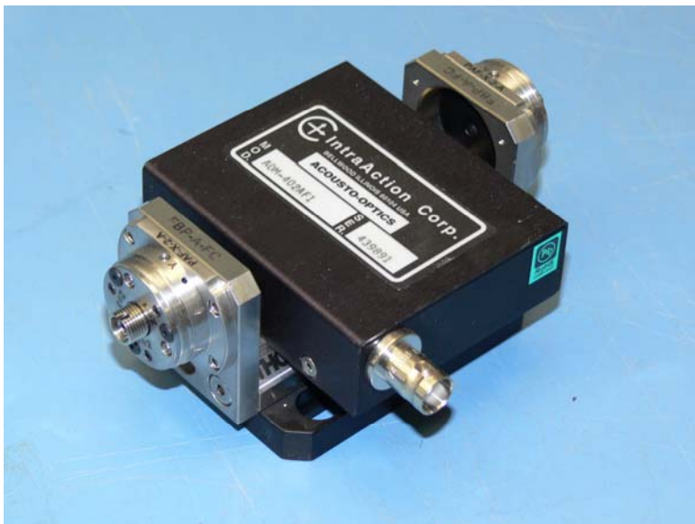
AOM in Koppereinheit mit FC-PC-Buchsen für Einbau in Geräteeinschub
