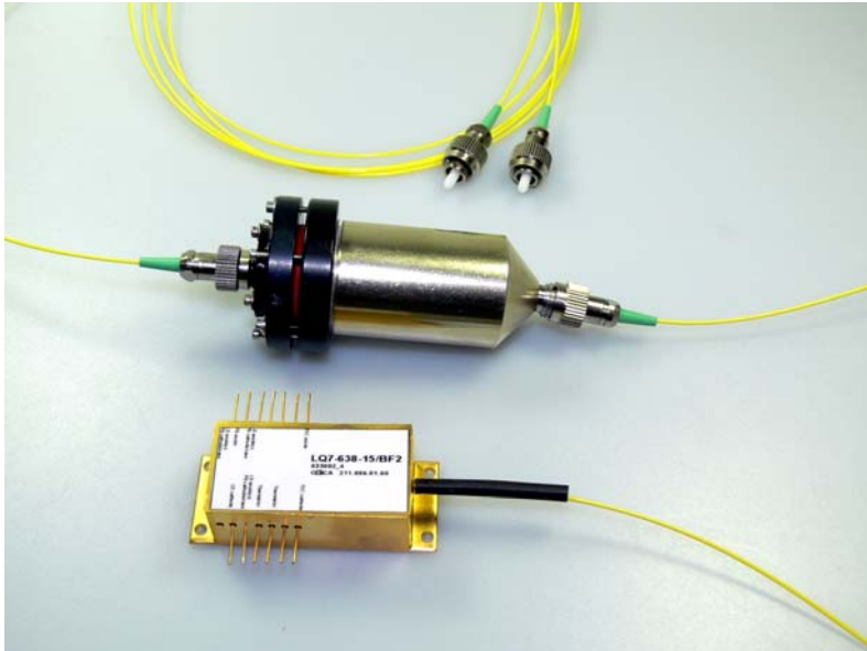
Laserdiodenmodul, darüber der optische Isolator und die durch den Y-Koppler aufgeteilten zwei Pigtails mit Steckerabschluss
