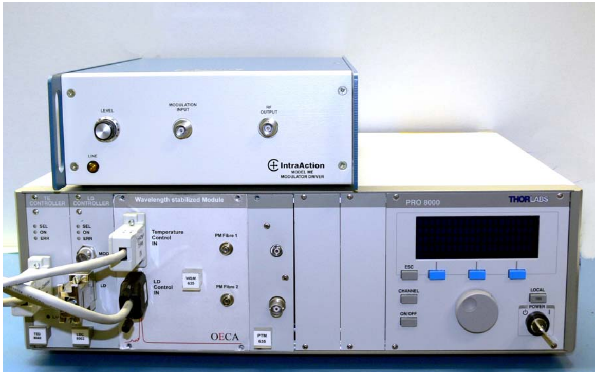
Komplettgerät mit Sendemodul, Empfangsmodul und AOM-Ansteuerung
