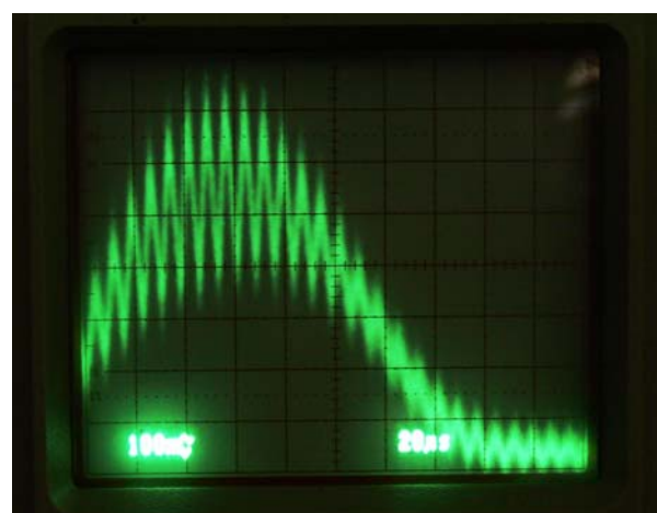
Messung mit SiPM (1 Skt = 100 mV)
